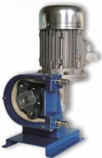
La pompe péristaltique est une machine qui met en application le principe du péristaltisme : une construction qui glisse sur le tube ; Grâce à l'élasticité du tube, une variation de pression se crée.
